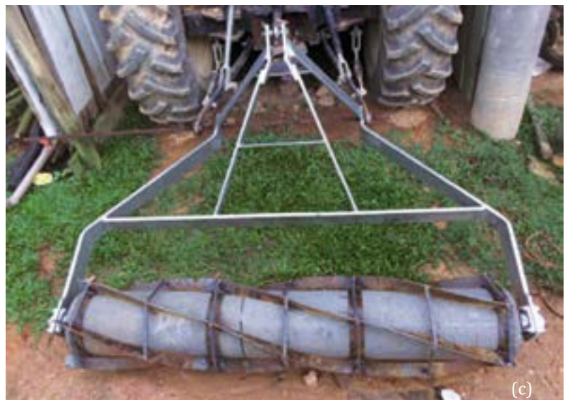
Figura 3. Rolo-faca tração por microtrator e trator sendo o primeiro (a) e o segundo (b) de tubo oco de metal para ser preenchido com água ou areia, e o terceiro (c) de tubo maciço de concreto. Todos esses equipamentos são eficientes para acamar as plantas de cobertura, porém, o primeiro (a) e o segundo (b) rolos-faca realizam cortes na palhada promovendo a morte rápida das plantas de cobertura, acelerando a degradação da palhada e reduzindo o tempo e a eficiência da cobertura do solo. O terceiro (c) realiza o acamamento sem corte, prolongando o efeito da cobertura do solo, mantendo as plantas acamadas vivas por um período mais longo.
