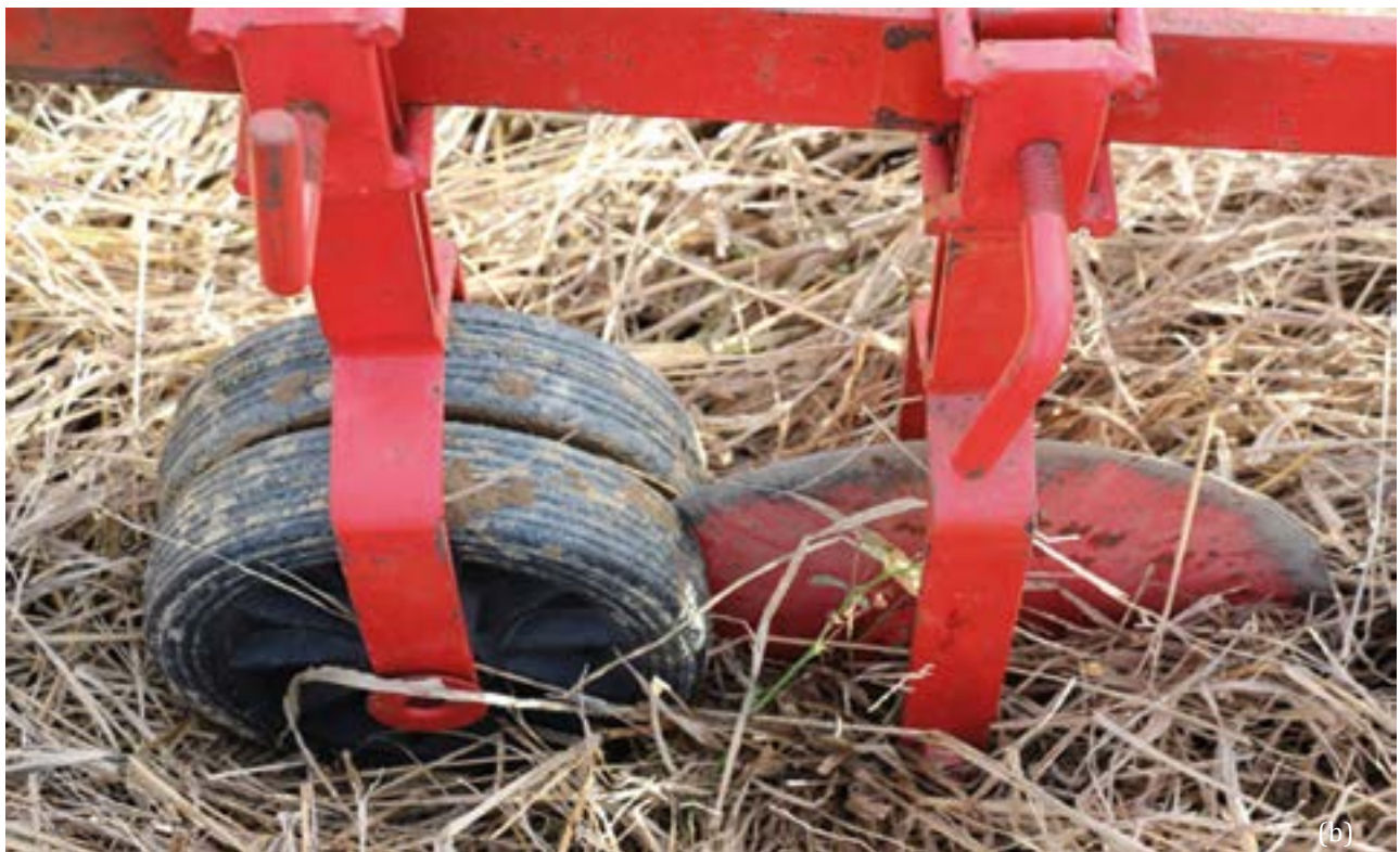
Figura 7. Detalhes de dois equipamentos onde o primeiro apresenta disco de corte corrugado e sulcador com terminal em dedo de ema de 2 cm de largura, que ocasiona fraturas no solo de baixo para cima como um “mouchão invertido”, com a vantagem de evitar a exposição do solo desde que usado na velocidade de trabalho correta (a). O segundo modelo tem o disco de corte liso, mas as rodas firmam a palha para facilitar o corte (b).
