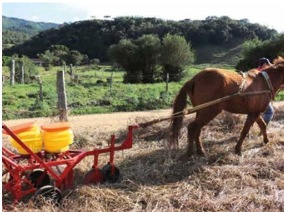
Figura 4. Equipamentos a tração animal para agricultura de montanha sendo que ambos realizam corte das plantas de cobertura e preparo do berçário. A diferença está na deposição do fertilizante feita pelo segundo modelo. É um equipamento de alto rendimento de trabalho sem o custo adicional de máquinas de tração motora e gasto de combustível. Além disso, tem a vantagem de apresentar baixo índice de compactação do solo.
