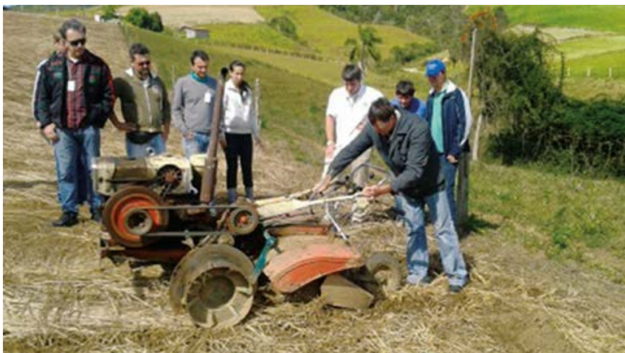
Figura 6. Equipamentos com tração por microtrator desenvolvido para cortar plantas de cobertura e construir o berçário em linha, com roda de ferro contendo disco de corte com 24", porém, com rotativa adaptada para duas linhas com espaçamento varável (0,8 a 1,0 m) revolvendo 6 cm de largura. Neste equipamento as facas da enxada rotativa são desgastadas para revolver o mínimo de solo. Atrás das enxadas são posicionadas calhas de metal que evitam que o solo seja projetado para longe da linha de cultivo. É um equipamento desenvolvido para preparar berçário de cebola, porém, pode ser utilizado para outras hortaliças como as brássicas. O corte de palhadas resistentes, como de mucuna, é garantida pela substituição dos pneus do microtrator pela roda de ferro especial com disco de corte. Uma vez que grande parte do peso da máquina recai sobre os discos, o corte da palhada torna-se mais fácil que em outros equipamentos mais leves.
