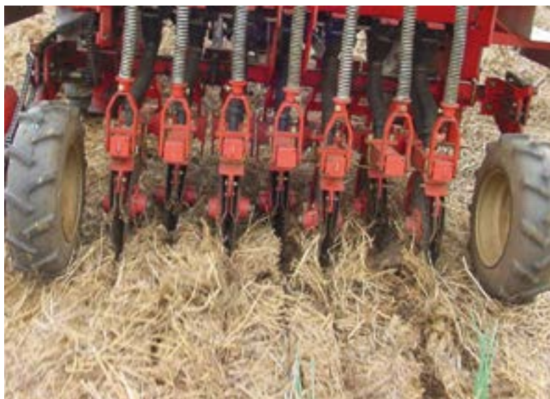
Figura 1. Equipamento montado no trator, acoplado ao sistema hidráulico, com apenas discos duplos desenvolvido para alocar sementes de adubos verdes de inverno e verão. Corta resíduos de plantas de cobertura e deposita as sementes sub-superficialmente.
