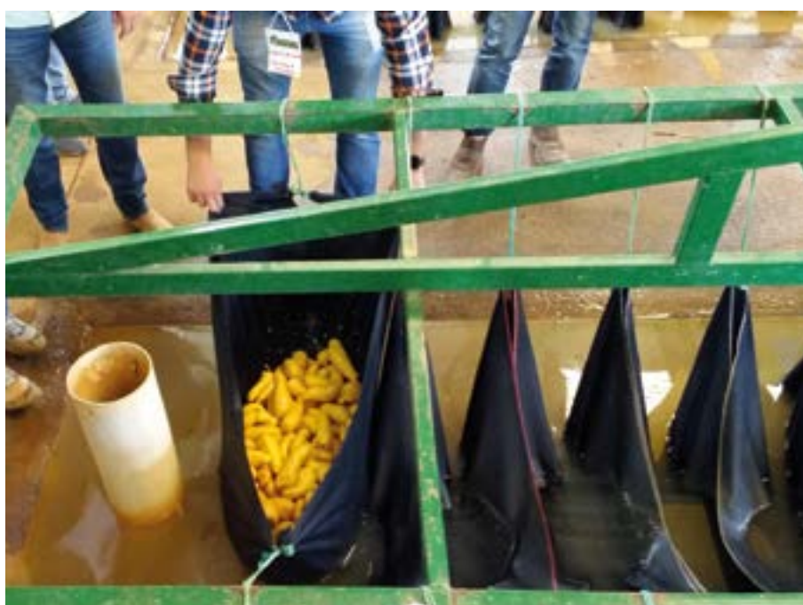
Figura 26. Lavador pendular com panos pendurados em um quadro movido por força motriz excêntrica, acionado por motor elétrico em Senador Amaral/MG, 2018.
