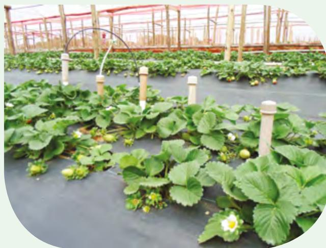
Figura 9 - Bateria de tensiômetros utilizados no monitoramento da umidade e lixiviação de nutrientes no solo em cultivo orgânico de morango em Ibiúna/SP.
