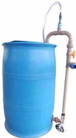
Figura 3. Unidade Portátil de Produção do Biofertilizante
